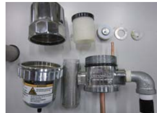
③ドレントラップの分解・清掃
