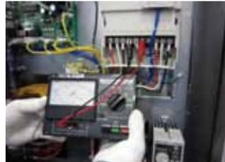
②インバータ静電容量測定
